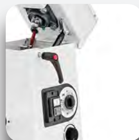
Variador de velocidad.
